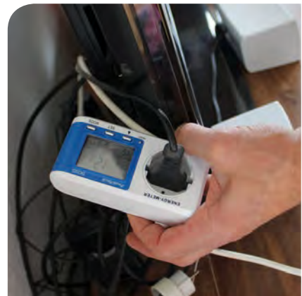
Energiecheck enttarnt Stromverbrauch im Standby-Modus. Foto: Edelmann
